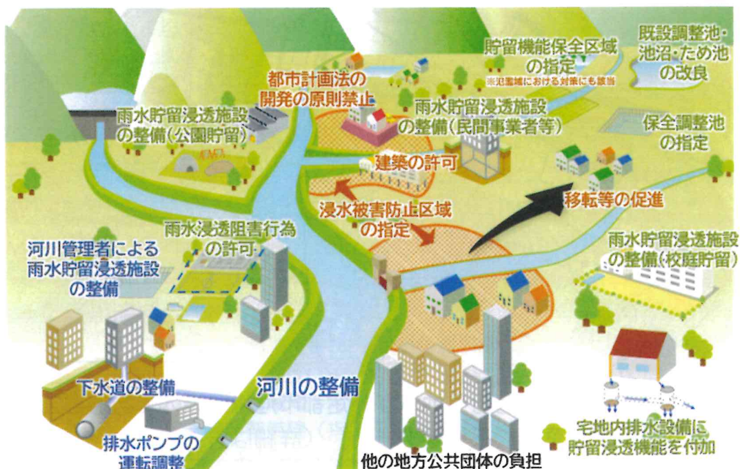
「流域治水」の考えを取り入れた 特定都市河川・流域での様々な被害軽減対策（イメージ）
